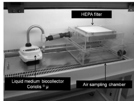
コリオリスエアサンプラーを HEPA フィルター付きサンプリングチャンバー(50x50x20cm) に直接接続。
